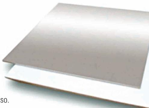
Placa de yeso desmontable con la cara a la vista revestida con vinilo blanco, la parte superior con foil back de aluminio y revestido en sus bordes con una cinta para que no desprenda yeso.
