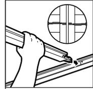
**Instale las T transversales.** Inserte las lengüetas en las ranuras en la T principal. Donde dos T transversales ocupen la misma ranura, inserte la segunda T transversal a la izquierda de la primera T transversal.
