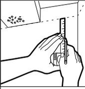
**Seleccione una altura de techo.** Deje una distancia libre mínima de 4" debajo del conducto de aire, tubería o viga más bajos. Trace una línea de tiza a 3/4" arriba de la altura de techo deseada.
