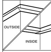
**Corte las esquinas.** En las esquinas exteriores, corte en inglete los ángulos de pared a 45 grados. En las esquinas interiores, corte los ángulos a 90 grados y colóquelos a tope.
