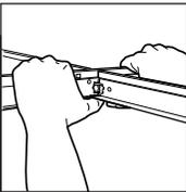
**Para retirar una T transversal,** empuje hacia arriba la T principal y gírela hasta que la T transversal sobresalga.
