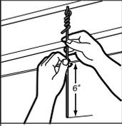
**Instale los alambres de suspensión.** Instale tornillos con rosca para madera a intervalos de 4' a lo largo de las líneas de cordel de las T principales. Fije un alambre de suspensión en cada tornillo y corte 6" debajo de la línea de la cuerda. Pliegue cada alambre de suspensión con un ángulo de 90 grados a 3/4" arriba de la línea de la cuerda.
