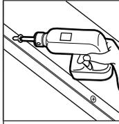
**Instale los ángulos de pared.** Alinee la parte superior de cada ángulo de pared con la línea de tiza. Separe los tornillos a cada 2' entre centros o menos.
